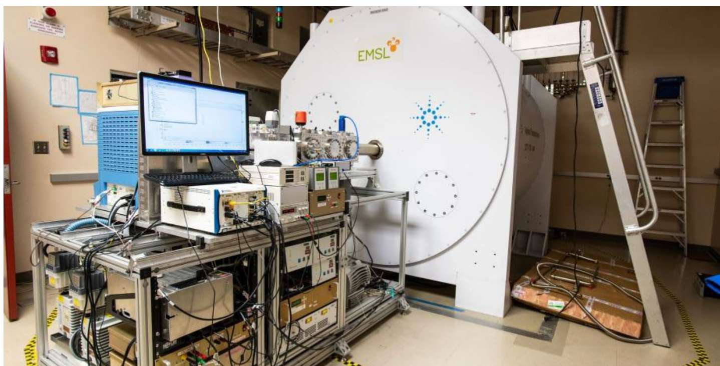
Bruker 7 Tesla FT-ICR-MS at PNNL
